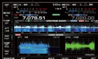
Mini spectrum scope and audio scope
