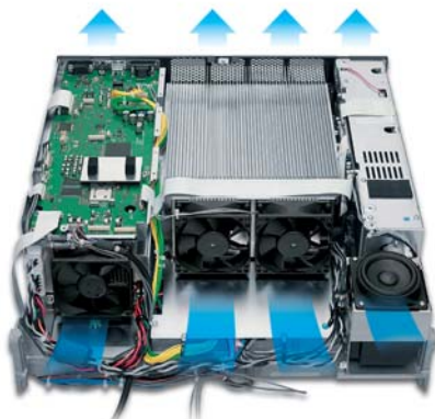
Quad cooling fan system
