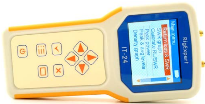
jednopunktowy pomiar strat obwodu i SWR
